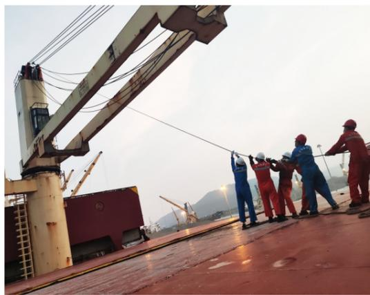
10月8日“金海正”轮在越南卸钢材,20吨克令吊钢丝绳扭转缠绕,无法卸货。经过探讨,必须更换钢丝绳。为抓紧时间抢修,甲板部、轮机部人员齐心协力,高喊最美口号:“安全第一,安全顺利抢修完工。一丝不苟海运人,齐心协力正能量!”(金海正轮)
